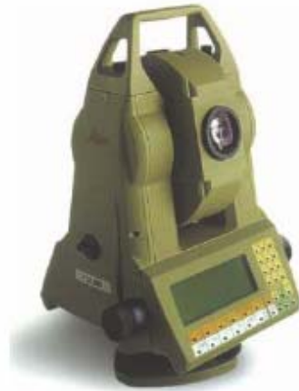
Figura 9: Equipo de auscultación robotizada Leica TCA-2003
